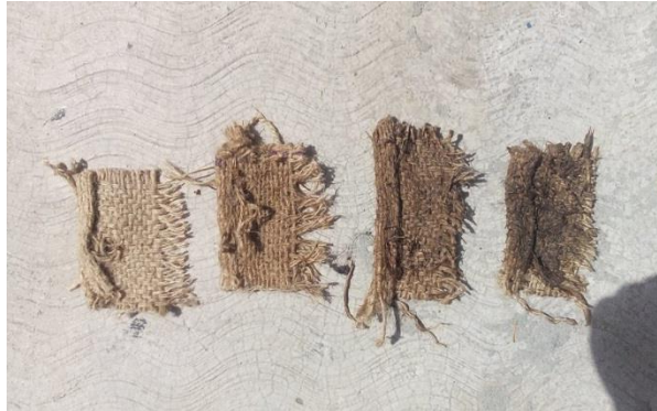
Figura 17. Escala comparativa visual de coloración del yute para mediciones de humedad
