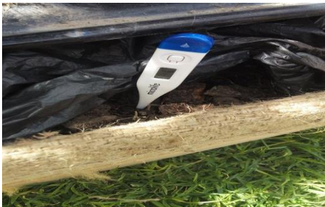
Figura 21. Termómetro digital para medición de temperatura de la composta
