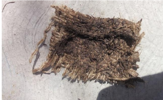
Figura 20. Yute con exceso de humedad
